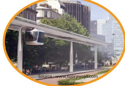
Supraways a une vitesse maximale de 130km/h, une capacité de 7200 passagers/h pour une vitesse entre 50 à 80km/h en ville
